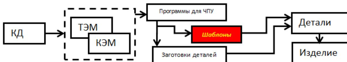
Рис. 1. Место шаблона в ЖЦ изделия серийного авиационного производства
