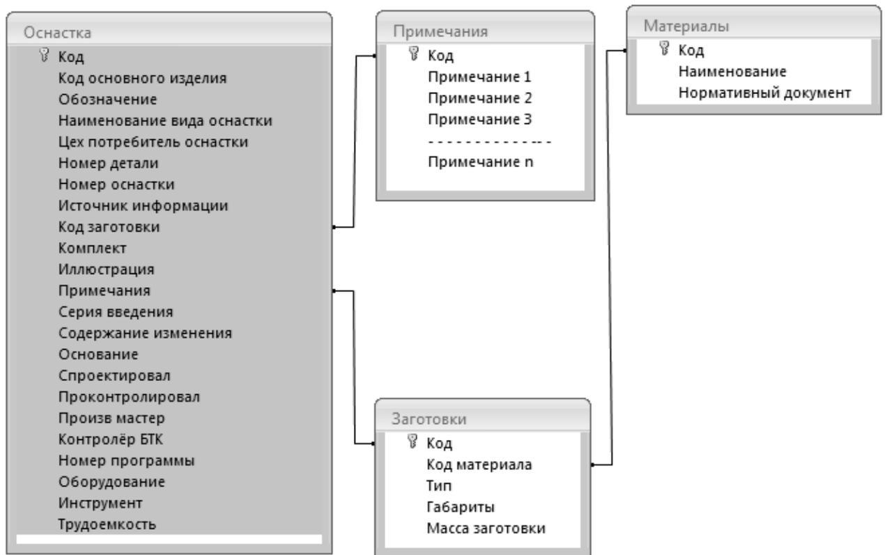
Рис. 78. Схема данных для сущности «Оснастка»
