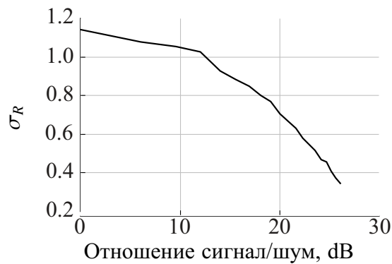
Рисунок 3.13 – Зависимость стандартного отклонения корреляционной функции от отношения сигнал/шум
