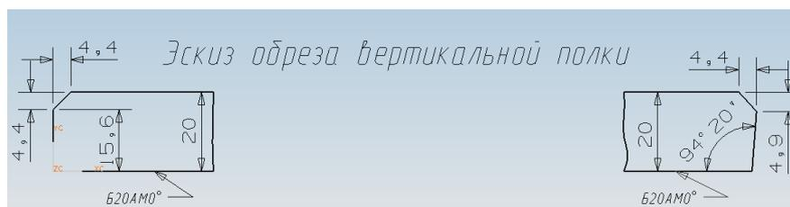
Рис. 4.9 Эскиз обреза вертикальной полки
