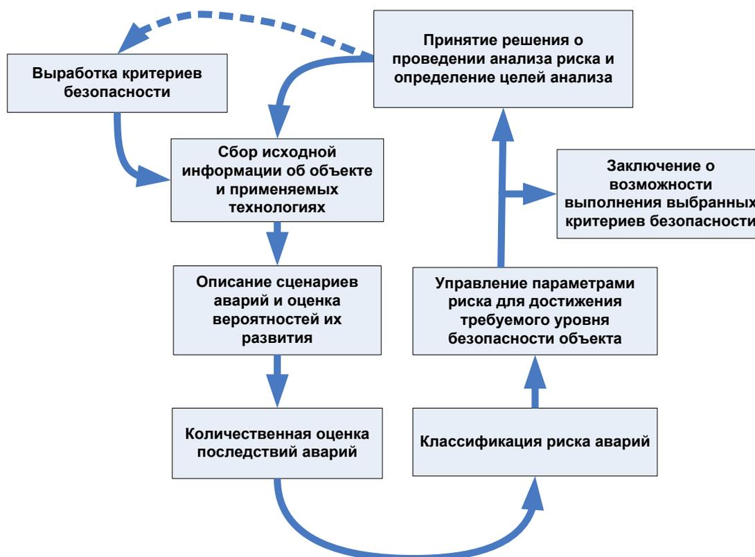
**Рис. 11. Единая схема проведения проектных процедур в области анализа риска возможных аварий в проектируемых ТС содержащих опасные вещества.**
