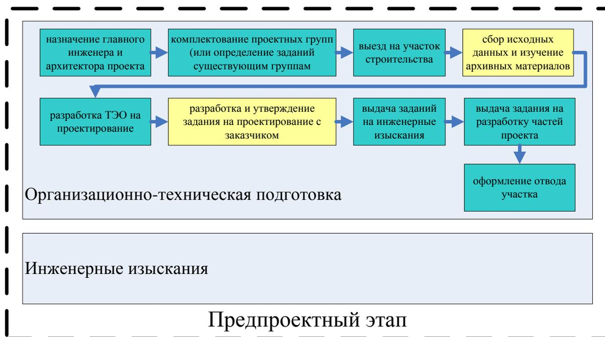
**Рис. 1. Схема выполнения предпроектного этапа проектирования.**
