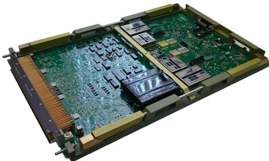
Рисунок 4.12 – Модуль типа МВФ разработки АО «УКБП», применяющийся в качестве вычислителя в КБО ИМА
