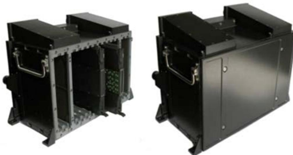
Рисунок 1.4 – Крейт 6U 10M производства
