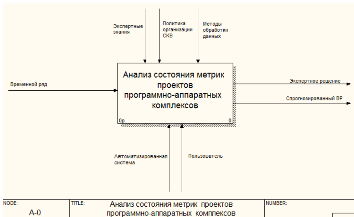
Рисунок 3.1 – Контекстная диаграмма «Анализ состояния метрик проектов программно-аппаратных комплексов» (нотация IDEF0 )
