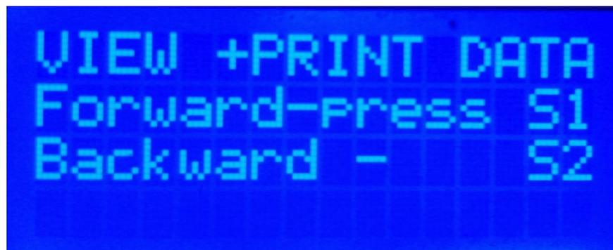
Рис. 4.7. Вид экрана ЖКИ при выборе режима просмотра данных
