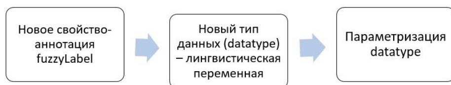
Рисунок 1.5 Схема задания нечеткого отношения в нотации FuzzyOWL
