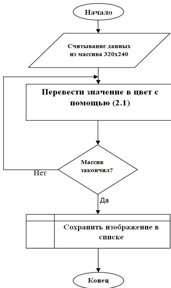
Рис. 2.3. Операция преобразования массива данных в изображение
