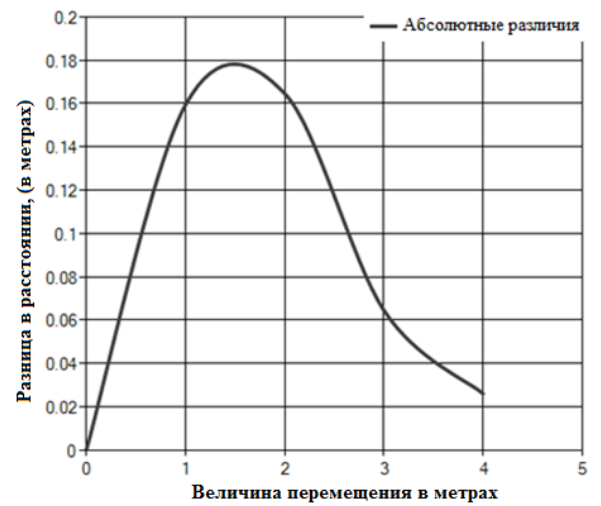
Рис.3.68. Результаты оценивания координат камеры по третьей точке и абсолютная погрешность оценивания
