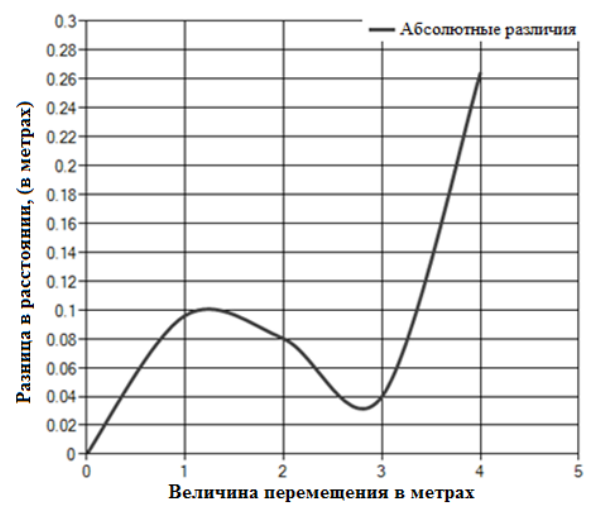
Рис. 3.70. Результаты оценивания координат камеры по пятой точке и абсолютная погрешность оценивания
