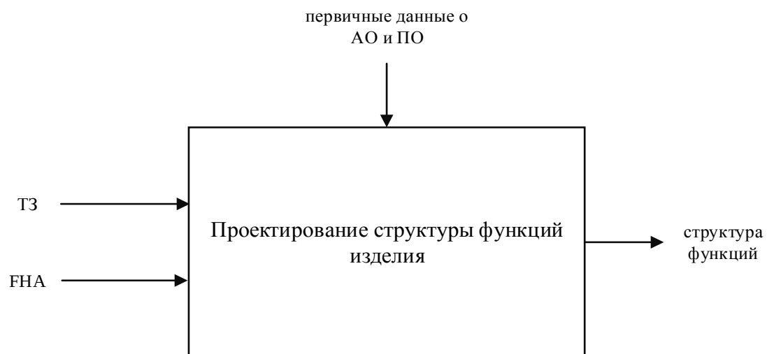
Рисунок 20 – Модель процесса проектирования структуры функций типа «черный ящик»
