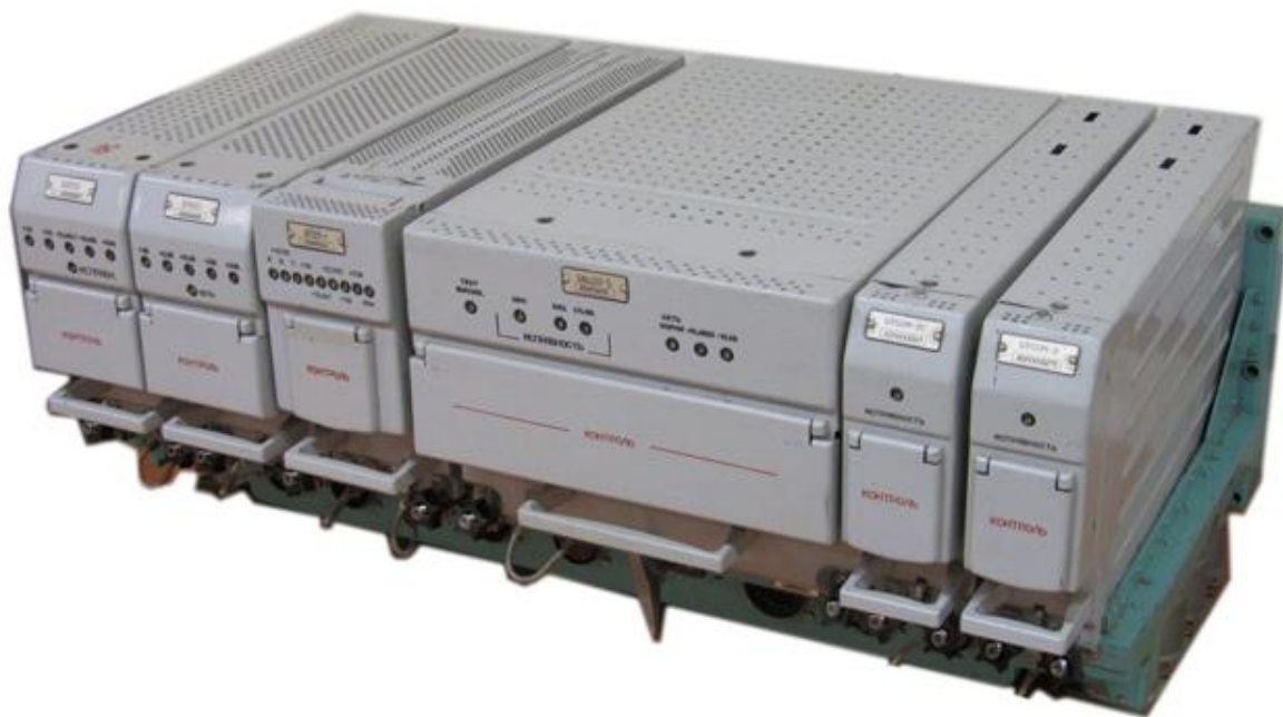
Рисунок 4 – БЦВМ «Орбита-20» образца 1969 года, производства АО «ОКБ «Электроавтоматика» [10]
