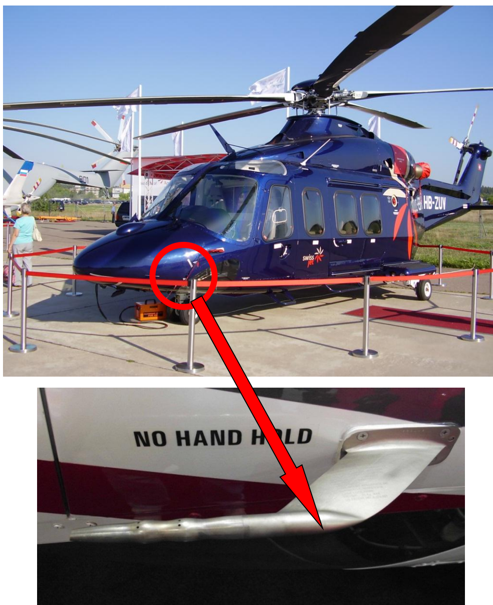
Рисунок 1.14 – Приемник воздушных давлений по патенту США 4378697 от 05.04.1983 на вертолете Augusta Westland AW139
