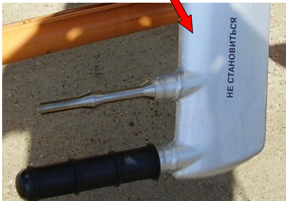
Рисунок 1.22 – Комбинированный приемник полного статического давления на многоцелевом вертолете Ансат
