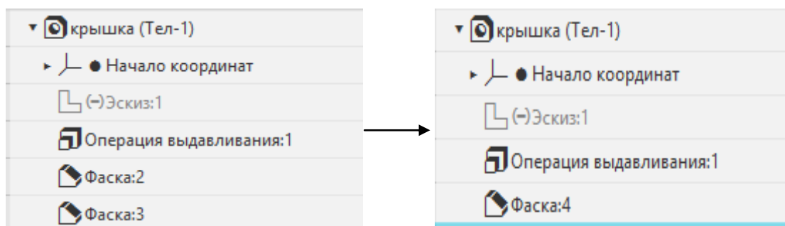
Рис. 2.18 Пример перестроенного дерева модели для повторяющейся операции с одинаковыми параметрами
