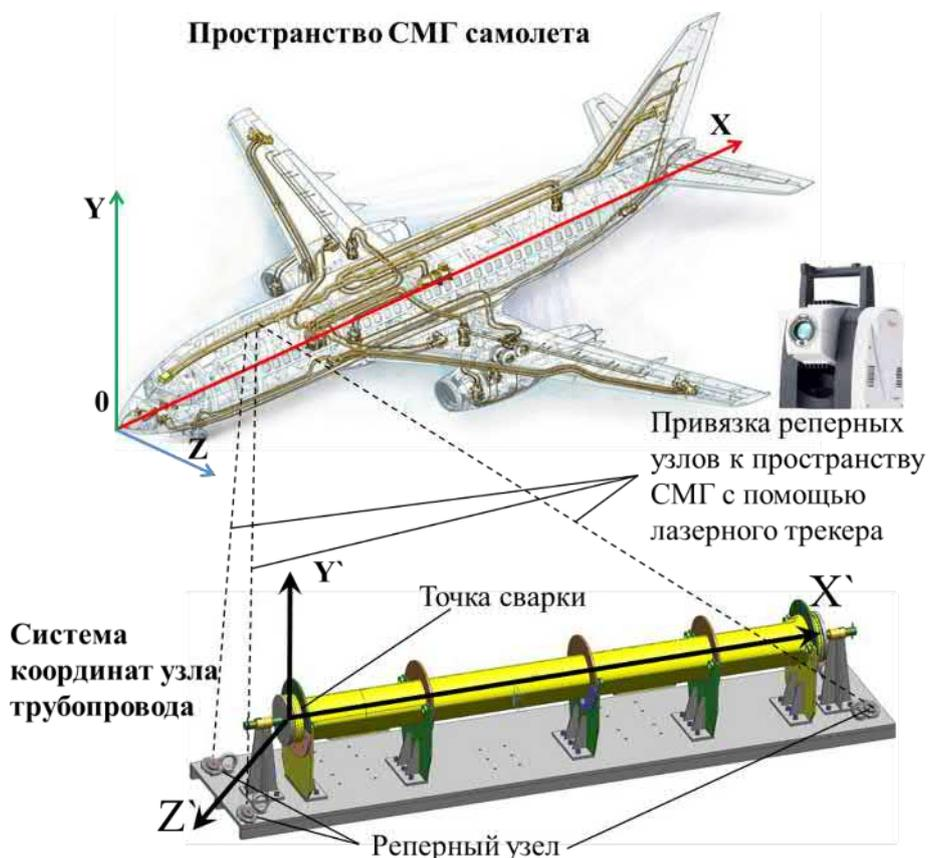
Рис. 4.14 Схема увязки СТО с пространством СМГ самолета
