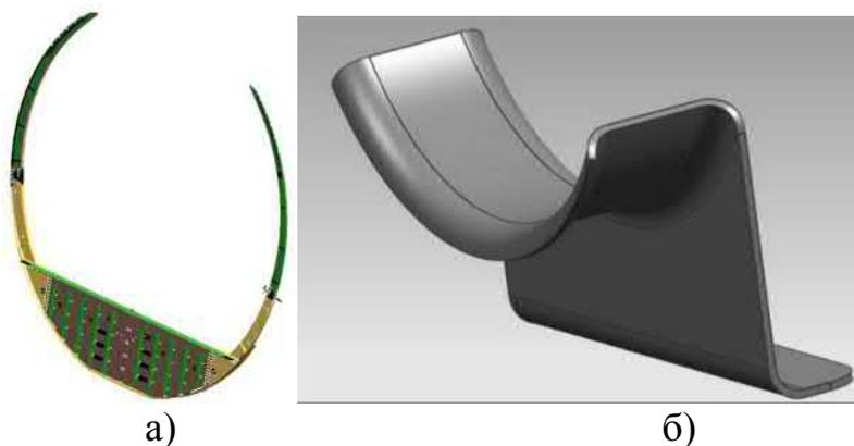
Рис. 2.6 а) составной шпангоут; б) фрагмент шпангоута (кронштейн навески трубопровода)
