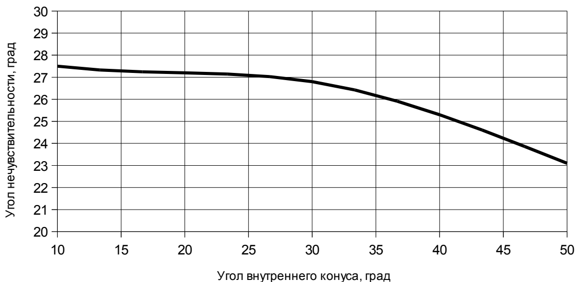
Рисунок 3.1 – Зависимость угла нечувствительности от угла внутреннего конуса приемника
