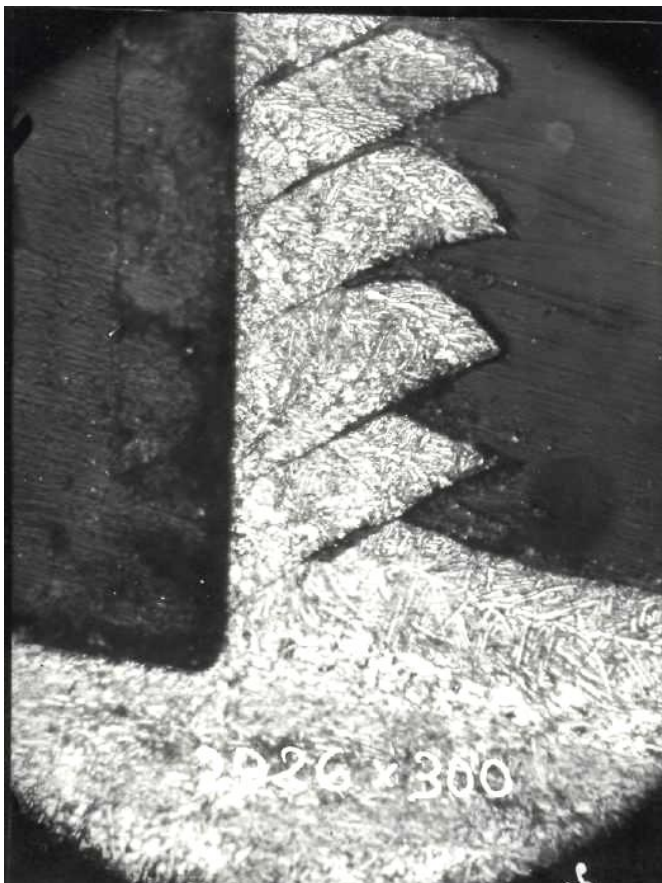
Рисунок 2.42 - Корень стружки, полученной при обработке титанового сплава ВТ 16
