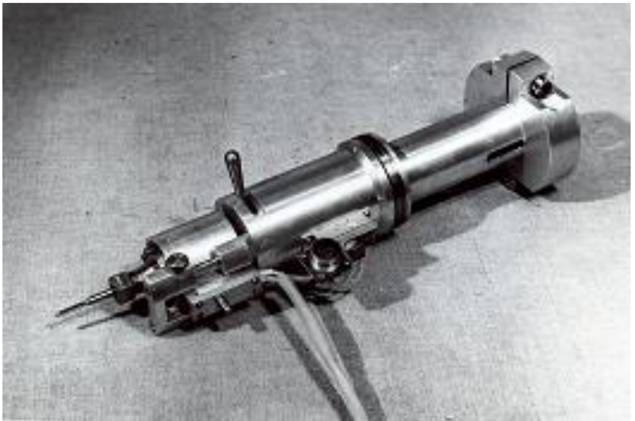
Рисунок 5.4 - Ультразвуковое устройство для нарезания резьб М2-М6
