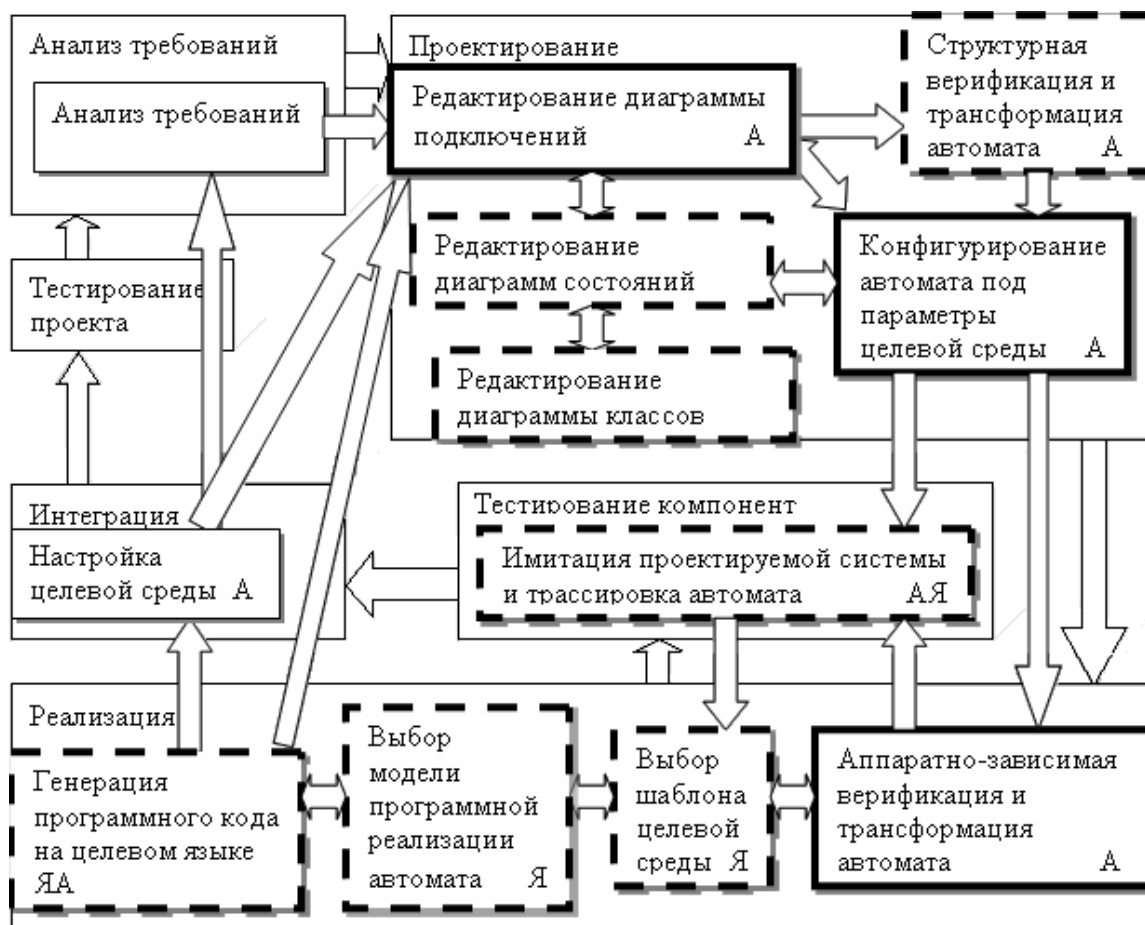
Рис. 1. Обобщенная схема проектного процесса автоматизированного проектирования программно-аппаратных реализаций автоматных диаграмм
