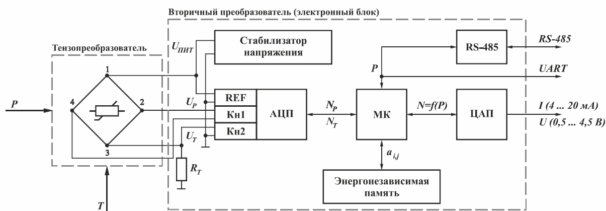
Рис. 1. Структурная схема датчика давления с цифровым методом коррекции температурной погрешности
