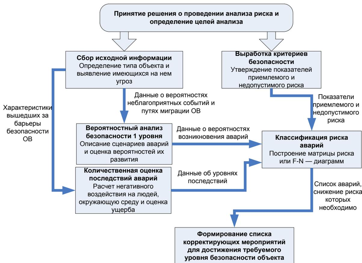
Рис. 2. Концептуальная схема компонента комплекса средств автоматизированного проектирования, отвечающего за исследование безопасности проектируемого объекта, содержащего опасные вещества
