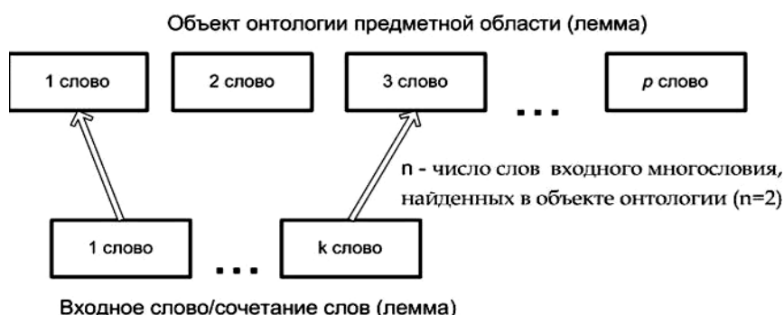
Рисунок 4 Тезаурусный алгоритм. Поиск опорного объекта
