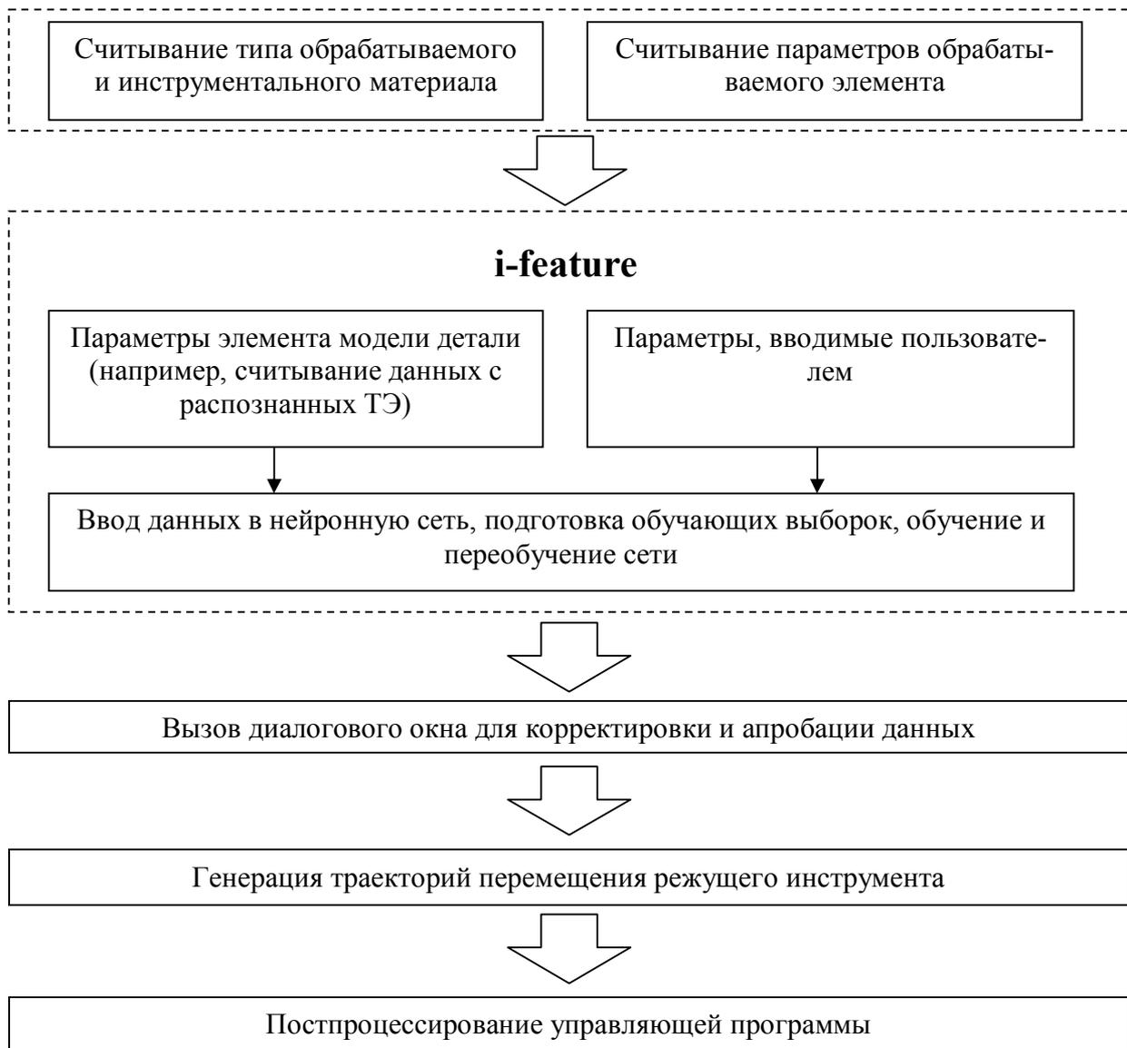
Рис. 3. Принцип работы предлагаемой системы «i-feature»
