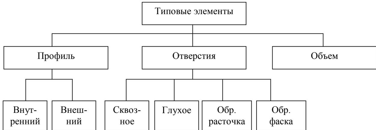
Рис. 1. Классификация типовых элементов
