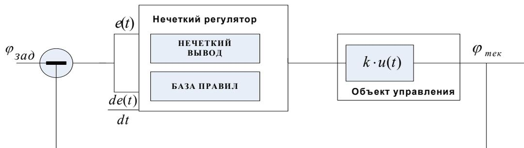
Рисунок 5 – Структурная схема САУД НПА с нечетким регулятором
