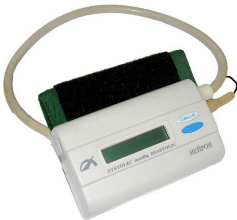
Рис. 2. Суточный монитор АД и ЧСС ИАДА-03Ул
